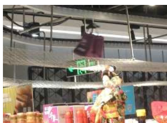
天井のレールで移送
